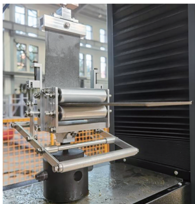
图2 预浸料剥离试验装置
