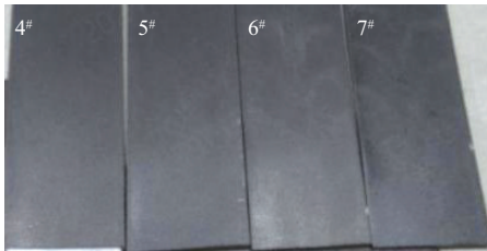
图3 样板近浇口侧光照后的表面状态
