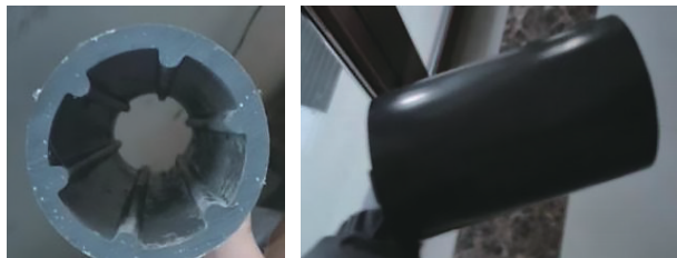
图9 矿用PE-UHMW托辊辊筒样品
