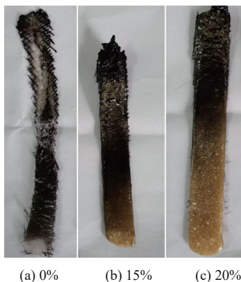
图17 燃烧后样品对比图(PI-MA-SPEPA质量分数:0%,15%,20%)
