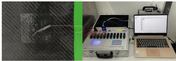
图12 CFRP感应加热层间温度场测量
