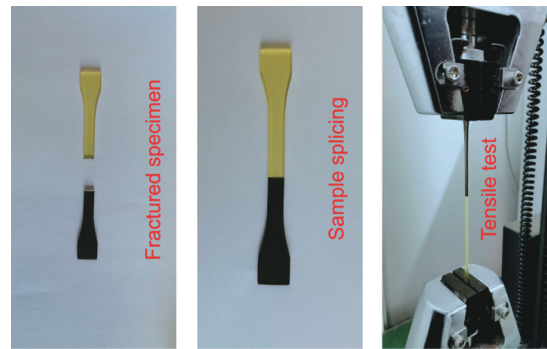
图10 PUUA-50弹性体自修复及修复后拉伸测试过程
