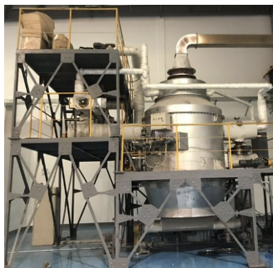
图6 树脂基复合材料纤维规模化连续处理回收装置
