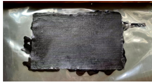
图2 涂刷阻尼溶液
