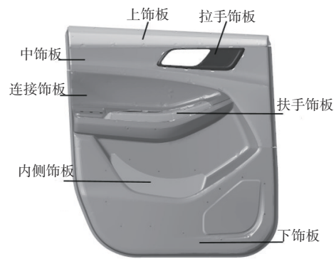
图1 车门内饰板结构组成
