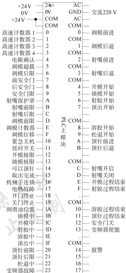
图 2 PLC 主模块输入输出信号
