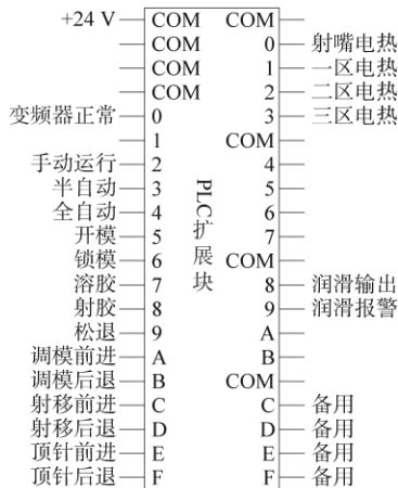
图 3 PLC 扩展模块输入、输出信号
