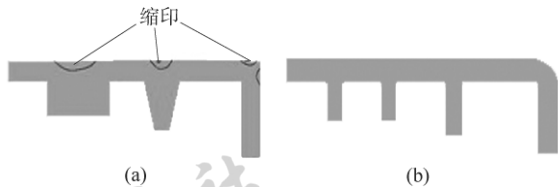
a—壁厚不均、尖角引起的缩印; b—正确设计
