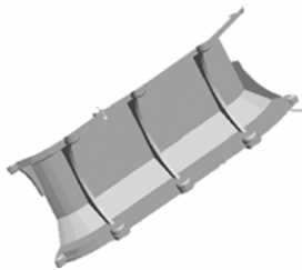
图2 复制生成的分型面
