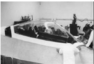
图 7 NGT 计划研制的注射成型风挡座舱一体化透明件
