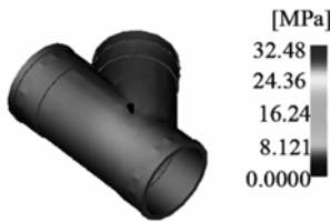
图5 单浇口充填过程模拟
