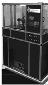
图 7 香港理工大学立式微量注塑机
