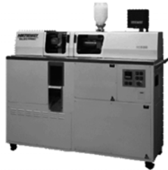
图4 日精树脂工业株式会社的 HM7-DENKEY 型微量注塑机
