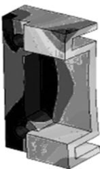
图 6 拓扑优化模板变形云图
