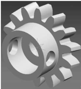
图 1 侧面带孔的斜齿轮实例图
