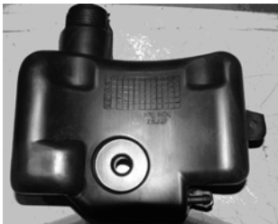
图 7 优化异型口模后成型油箱照片
