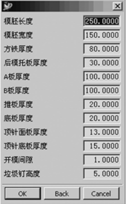
图 10 模架参数化输入框
