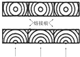
图1 多浇口同时进料形成的熔接痕
