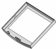
图 1 显示器面板三维图
