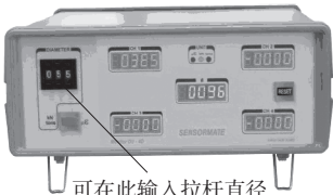
图12 拉杆应变及锁模力显示装置
