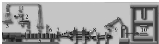
1—聚合物颗粒;2—喂料器;3—长纤维束;4—传动装置; 5—ZSK双螺杆挤出机;6—排气;7—切割;8—牵引单元; 9—机械传递;10—模压
