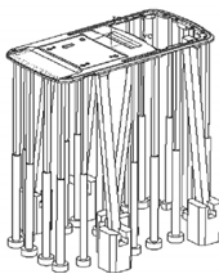
图 11 顶出系统的设计
