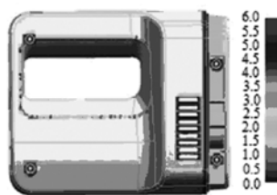
图 2 注塑件壁厚分析
