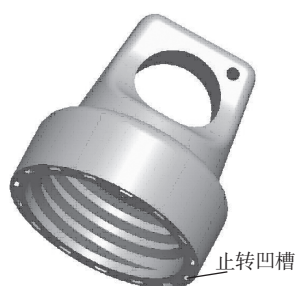
图6 瓶盖止转凹槽结构示意图
