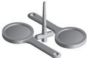
图 2 塑料放大镜浇注系统的三维图
