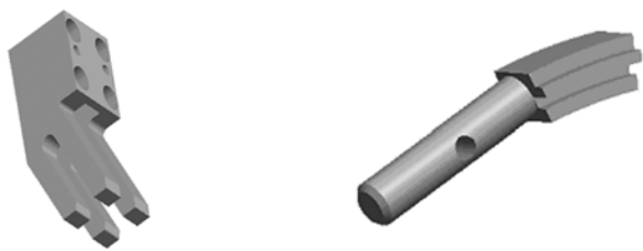
图4 斜导槽块 16 和圆弧侧型芯 15 的结构
