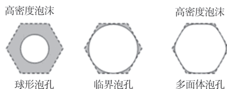
图4 相同泡孔大小的不同泡孔形状
