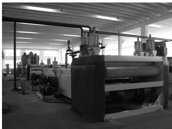
图1 双向拉伸塑料土工格栅生产线
