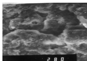
图9 断裂面微裂纹汇合区
