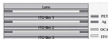
图3 电容式柔性触摸屏导电薄膜结构图
