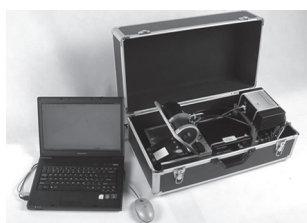
图 4 自制近红外退役汽车塑料材料识别系统
