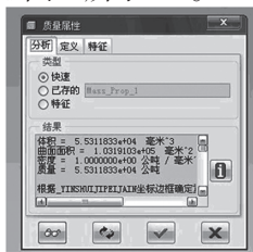
图3 利用 Pro / E 进行塑料件体积和质量分析
