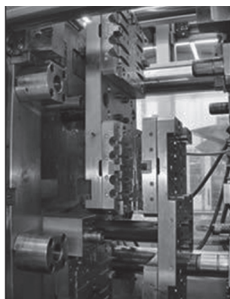
图1 Grosfilley公司的模内组装模具
