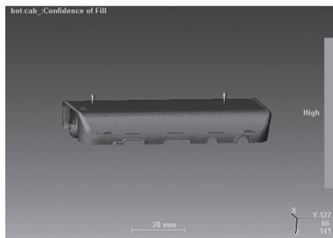
图 3 浇口布置图及充填质量
