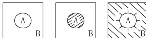
图1 “海-岛”结构增韧机理
