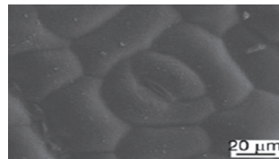
图 5 PDMS 复制的花生叶表面形貌 SEM 图
