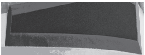
图 6 蜂窝稳定化处理及灌封料、层压板固化后形成的组合
