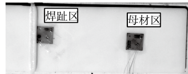
图 5 ABS-1 热焊板母材区和焊趾区测点位置
