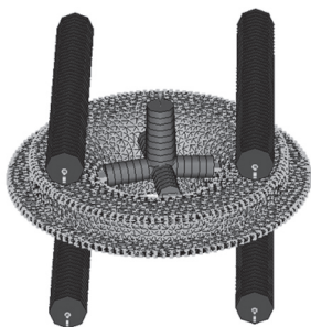
图2 高音喇叭薄膜浇注系统和冷却系统
