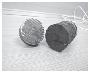
图4 不穿纱粘合制件的拉拔破坏照片
