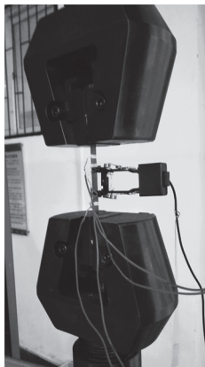
图2 CFRP拉挤板的单向拉伸实验
