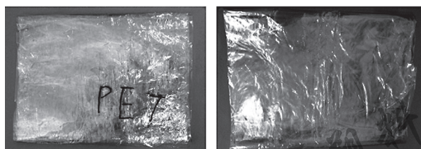
图3 PET及改性PET吹塑薄膜制品照片 扩链剂质量分数: a—0%; b—0.7%
