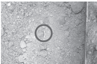
图 2 侵彻入结构后的弹体残留钢芯
