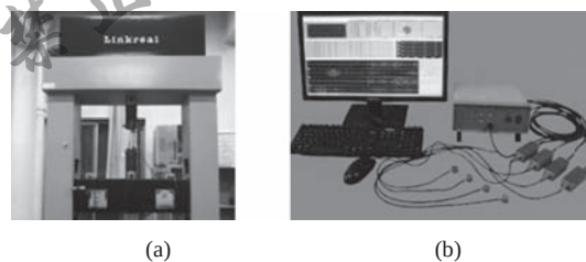
a—电子拉扭试验机; b—DS2声发射系统
