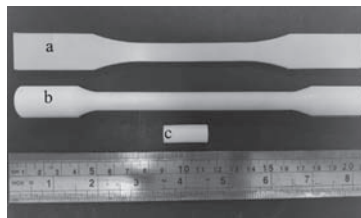
图 1 树脂狗骨状拉伸试样、圆柱体扭转试样及压缩试样
