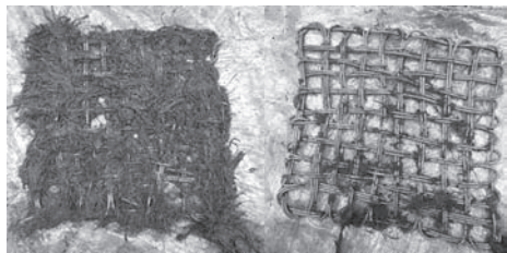
图 7 经海水腐蚀后渔网材料的微生物附着情况
