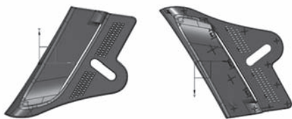
图1 注塑模型公模模面
