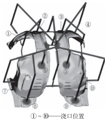
图2 流道及浇口布设示意图
